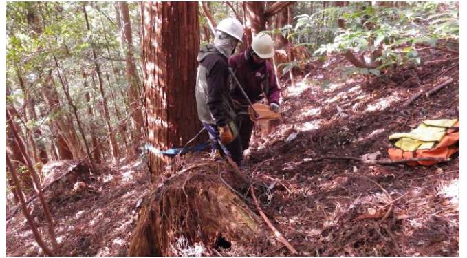
チルホール、レバーを使用して張力をつける (写真は張力をつける前の準備段階)
