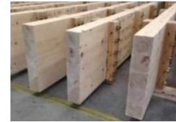
正角材を積層した重ね梁・束ね柱
