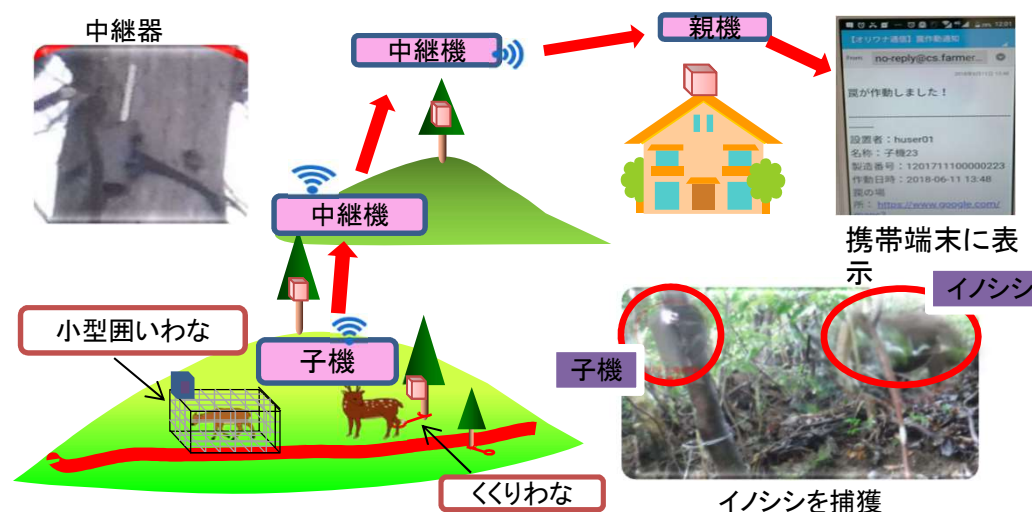
■簡易無線通信を活用したシカのわな遠隔捕獲通知システム
