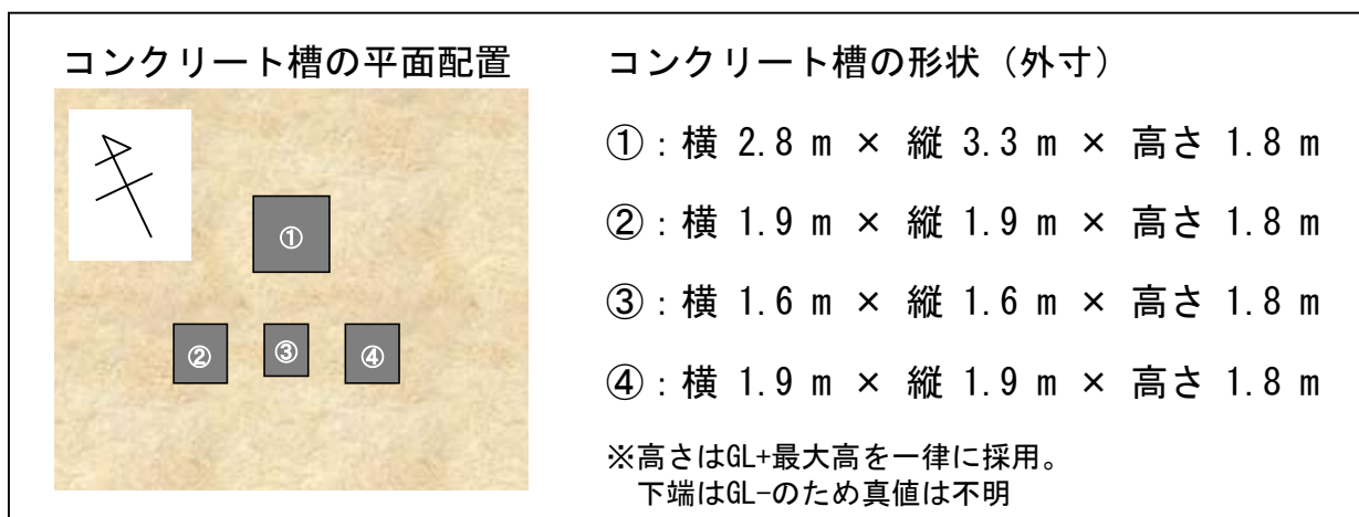
図 3-2 四万十町コンクリート槽配置概略図
