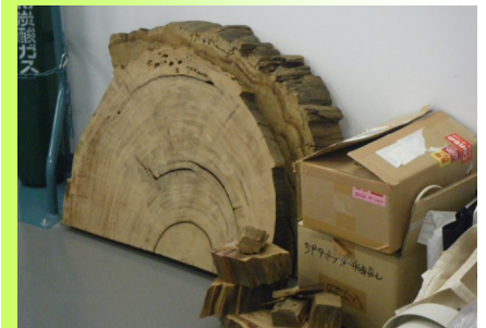
写真-1 分析用サンプルとして円盤の半分が小片化している (学習院大)
