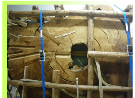
写真-2 分析用サンプルを取ったスジが多数ある円盤 (名古屋大)
