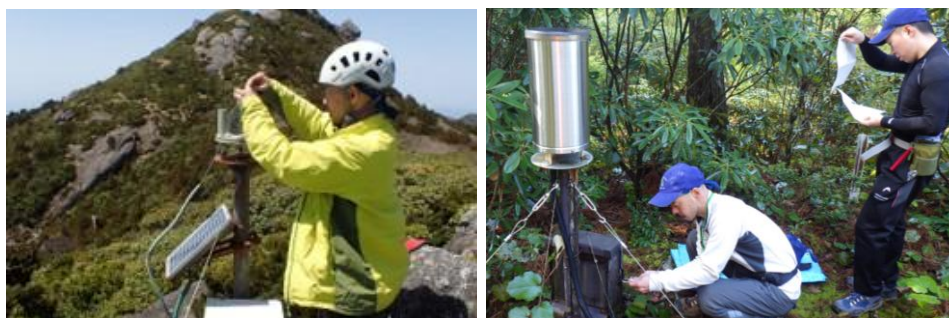
職員による雨量計(転倒マス)の清掃
