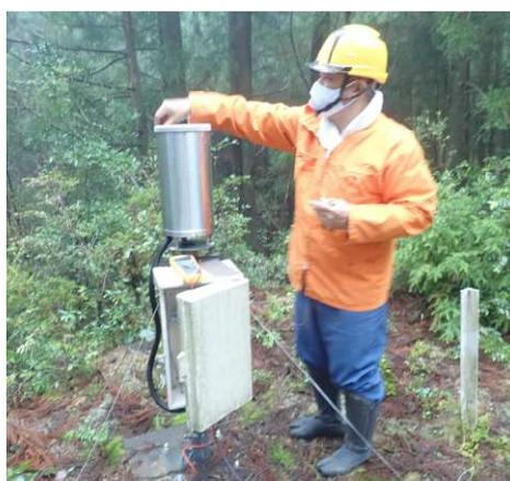
図3-1 観測機器(雨量計)メンテナンス
