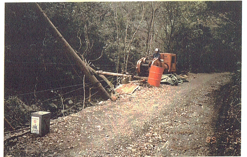
林道端に設置された集材機
