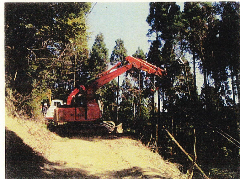
写真8 集材状況（スイングヤード）
