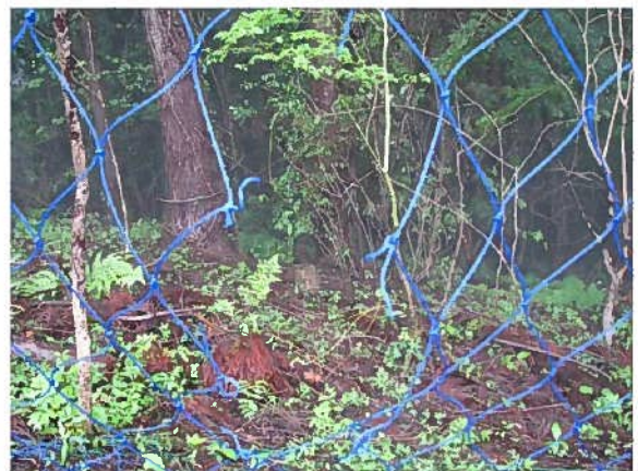
写真－ 15 斜め張りネットウサギ噛み切り 切断状況
