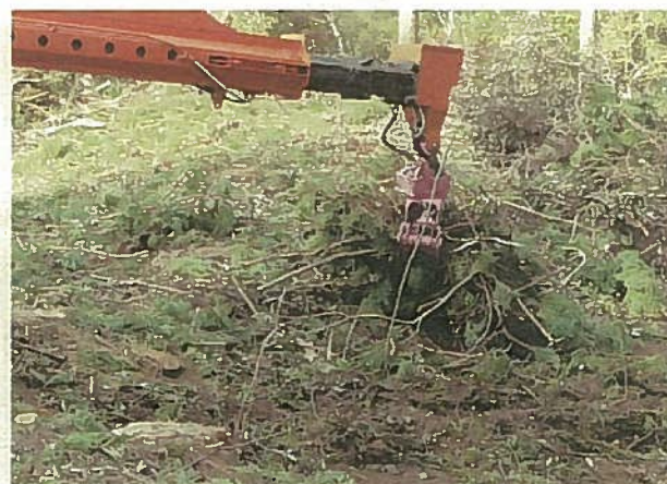
写真7 ロングリーチグラップルによる地拵状況
