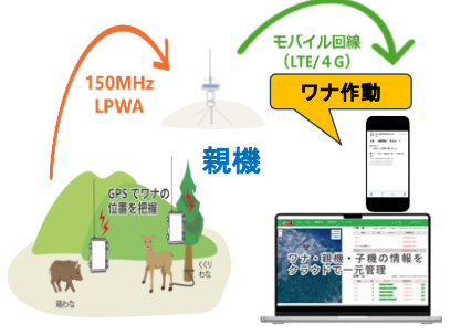
長距離無線捕獲通知システムの機能
