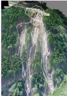
被害写真から測量を実施
