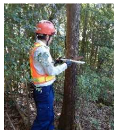
林尺を用いた従来の調査方法。対象木を1本ずつ測定。
