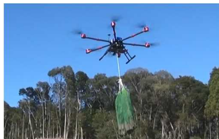
ドローンによる苗木運搬の様子 (高低差50m、直線距離300mを1回につき60本の苗木(コンテナ中苗)を往復約90秒で運搬)
