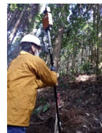
3Dレーザを用いた新たな調査方法。1箇所あたり45秒程度で半径10mの範囲の計測が可能。
