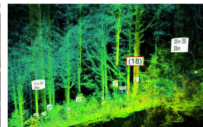
3Dレーザを用いた新たな調査方法。1箇所あたり45秒程度で半径10mの範囲の計測が可能。
