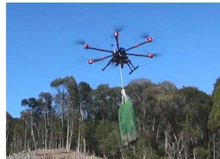
ドローンによる苗木運搬の様子 (高低差50m、直線距離300mを1回につき60本の苗木 (コンテナ中苗)を往復約90秒で運搬)
