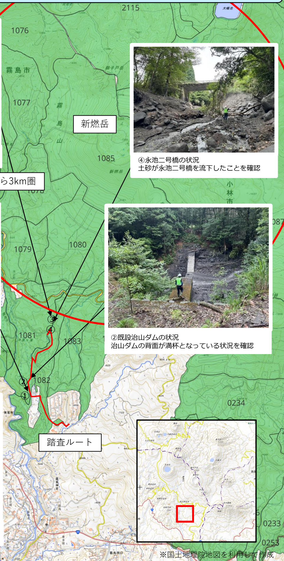
① 既設治山ダム背面の状況 治山ダムの背面が満杯となっている状況を確認
