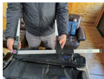
写真2 電子輪尺導入状況
