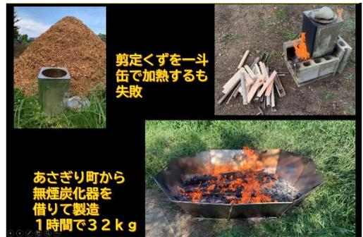
図4：バイオ炭の製造
