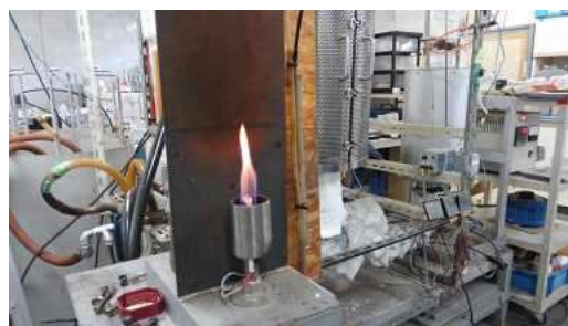
生成ガスを燃焼実験
