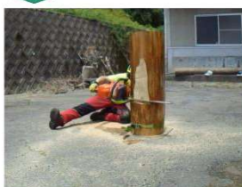
④伐倒方向を決める最も重要な“受口”を作る
