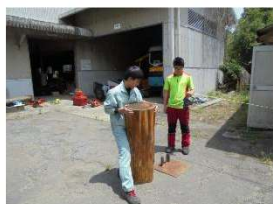
①土台に丸太を立てベルトで固定する
