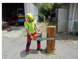
①伐倒木の側面を削り取る
