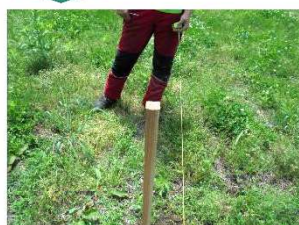
⑤水系を使って受口の伐倒目標とのずれを確認
