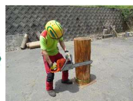
③反対側の側面も削り取る
