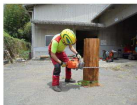
④伐倒方向を決める最も重要な“受口”を作る
