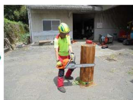
②次に、伐倒方向の面も削り取る
