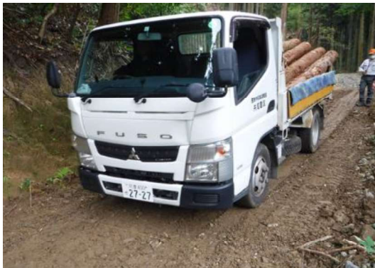
図 3 トラック走行試験
