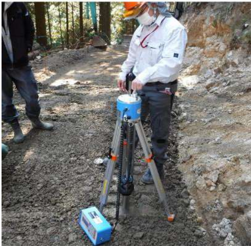
図 2 キャスポルによる支持力測定
