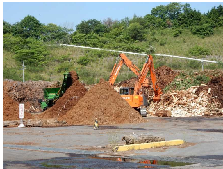
ハンマー式チッパーによるチップ製造
