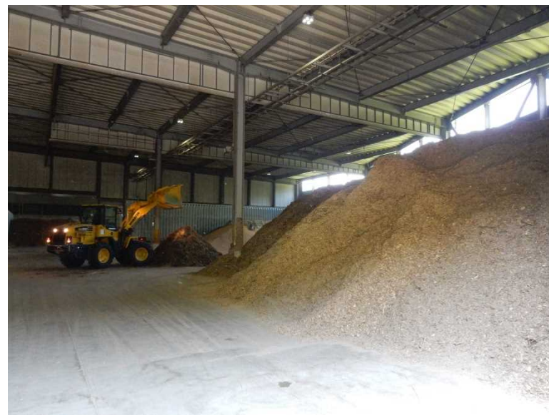
燃料投入設備内のチップ
