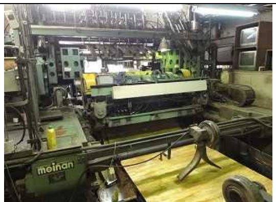
大根のように丸太を桂剥きしている様子。出てきた薄い板を適度な長さで切ったものが「単板」。
