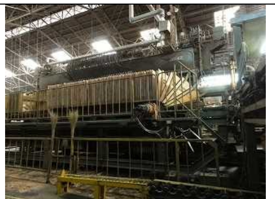
接着後、圧縮等の仕上げを行い、しなりや強度を持つ合板に加工されていく。
