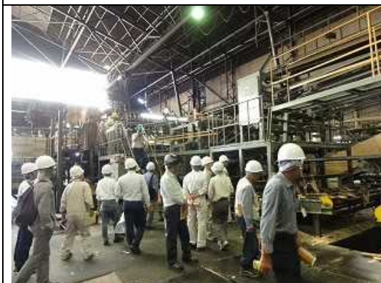
工場内の様子。薄い「単板」を重ね合わせて「合板」に加工していく。
