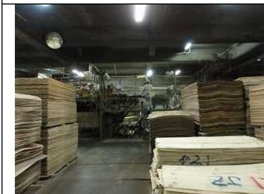
単板の反り方や水平・垂直方法といった向きを調整しながら、重ね合わせ接着していく。
