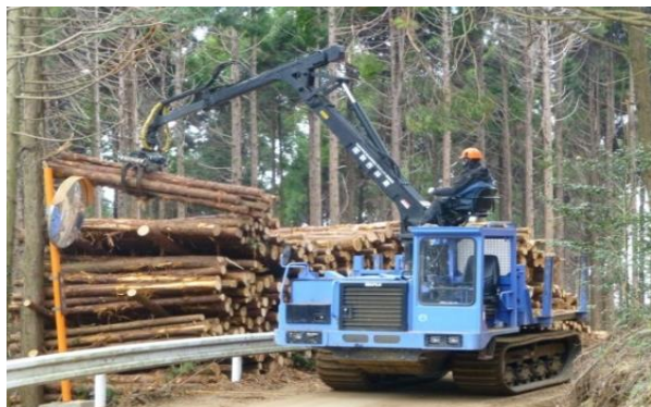
三ノ岳南面の森林整備（フォワーダー搬出間伐材） （荒強当国有林 155 林班）
