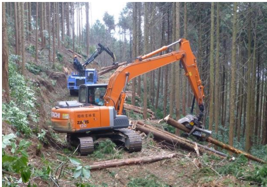
高性能林業機械による間伐材の搬出
