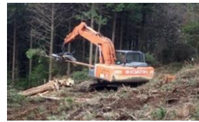
高性能林業機械による伐採・造材
