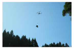
ドローンによるコンテナ苗運搬
