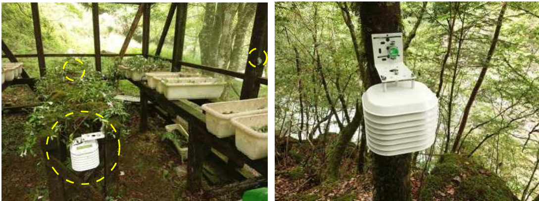
( 調査機材（データロガー）設置状況の様子 )
