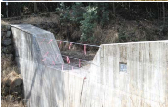
(上) 噴煙を上げる霧島山（新燃岳） (下) 治山施設に設置した土石流センサー
