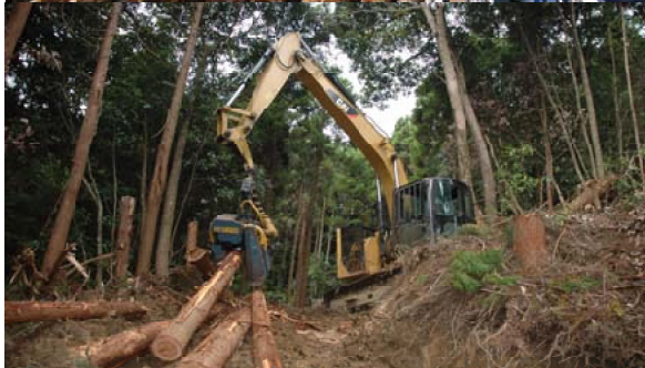
(上) 島外へ出荷＝屋久島地域・屋久島署 (下) ハーベスターによる造材＝日南市富土地域・宮崎南部署
