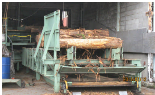
パーカーで皮剥ぎされる合板や集成材の原材料（B材）
