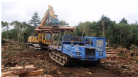
※伐採～木材搬出～コンテナ苗運搬 グループとフォワーダにより木材の搬出後、地拵が終了箇所コンテナ苗を運搬
