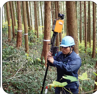
地上レーザースキャン計測器を設置
