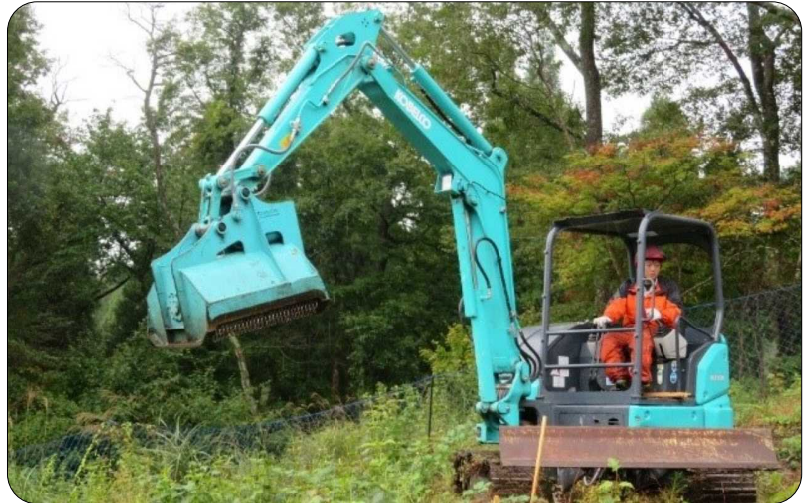
雑草やかん木を切るアタッチメントを装着したパワーショベル
