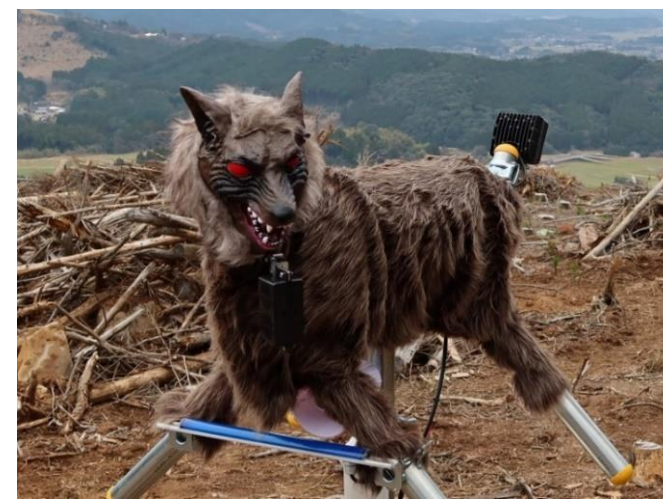
オオカミ型LED野生動物撃退装置（モンスターウルフ）と末木枝条による侵入防止、くくり罠による捕獲を組合せたシカ被害対策（北薩）
