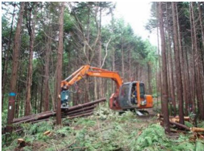
森林整備事業(保育間伐【活用型】)では、列状間伐を取り入れ、高性能林業機械を活用した作業仕組みによる低コスト作業システムを実施しています。
