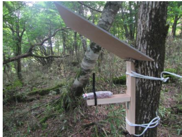
タイマー機能付きICレコーダー設置状況
