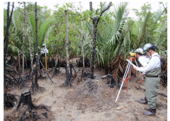
地盤高の調査
