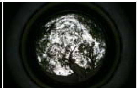
開空度撮影(平成20年11月)
