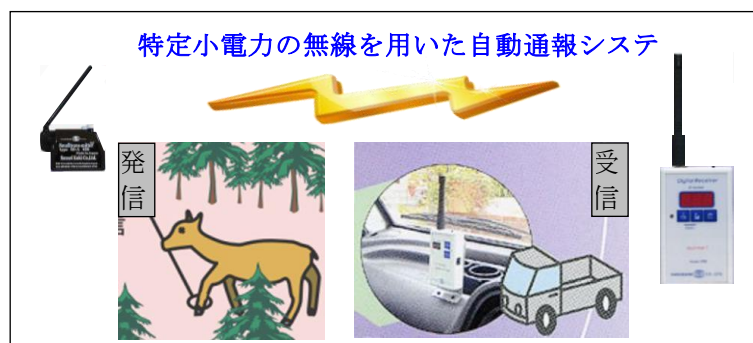
図 3-3 捕獲の検証に用いる無線を用いた自動通報システムの概要
