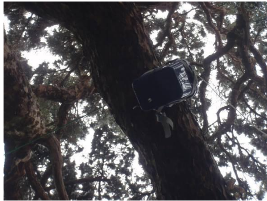
高さ 6m の木の枝に吊るした中継器
