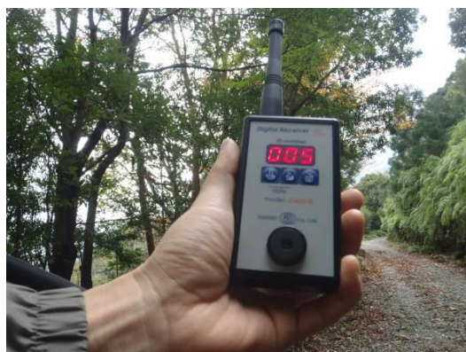
自動通報システムの受信機
