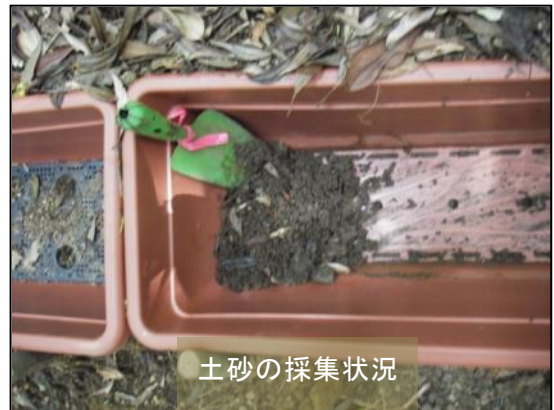
写真 2-1-4 現地における流出土砂とリター（落葉落枝）の採集状況
