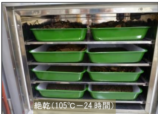
写真 2-1-5 流出土砂とリターの室内測定状況
