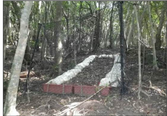
写真 1-2 表面土砂流出のモニタリング
