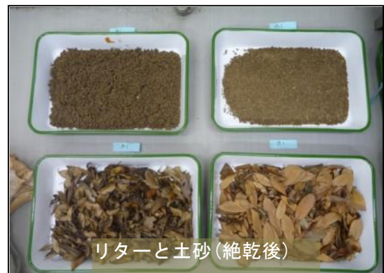
写真 2-1-5 流出土砂とリターの室内測定状況
