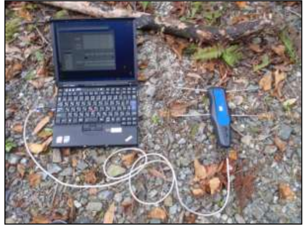
写真 2-2-35 データ収集用レシーバーとパソコン
