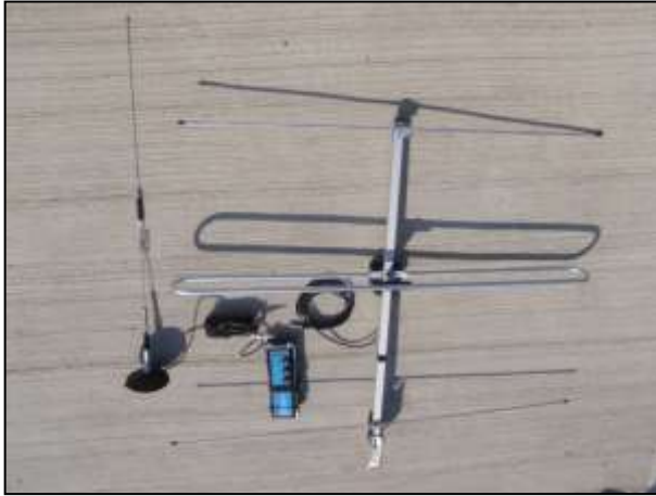
写真 2-2-34 データ収集のためのアンテナ類
