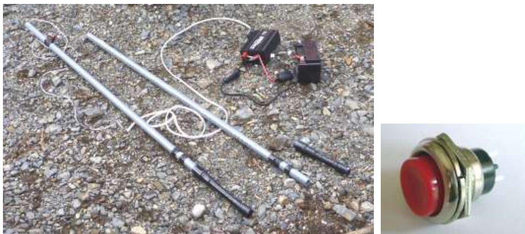
写真 2-2-2 簡易電殺器一式とモーメンタリ式スイッチ
