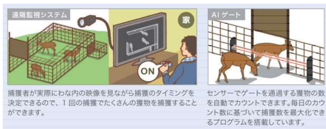
図 1-2-5 囲いわなにおける各種出入口閉鎖装置
