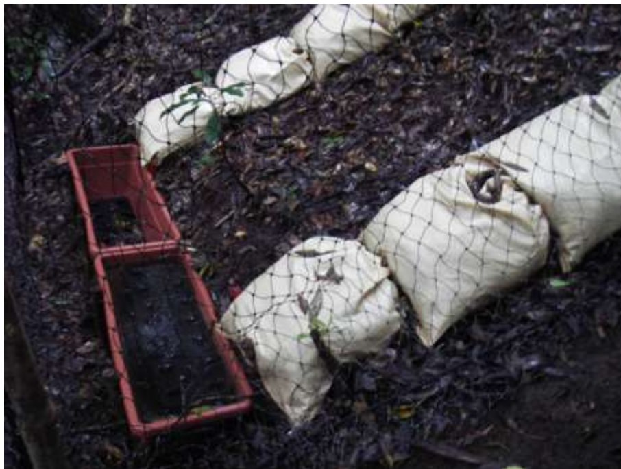
写真 2-5-4 降水時の土砂流出測定装置（南部地域〔尾之間〕の南 1〔植生保護柵内〕）
