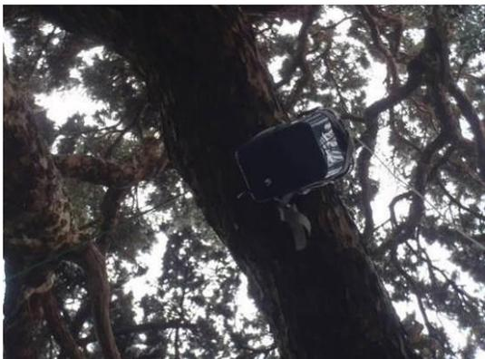
高さ 5.5mの木の枝に吊るした中継機
