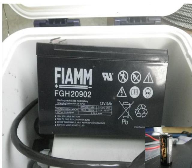
写真 3-18 バッテリー；中継機に使用した「FG20902」と発信機に使用した「CR123An」（右下）
