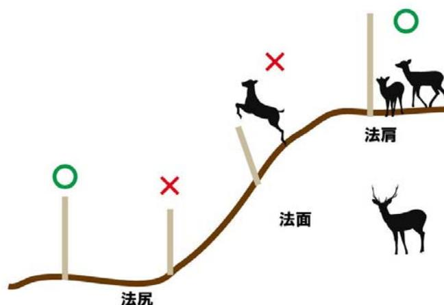
図 2-9-5-1 傾斜地での恒久柵設置ポイント
