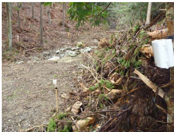
写真 2-4-3-2(2) 爆音器設置状況（地点No.05-2） （左：センサー、右：発声器）
