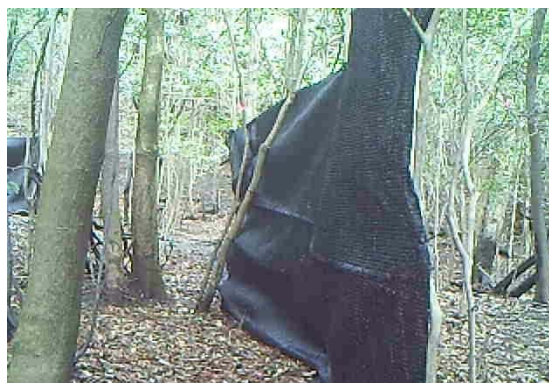
写真 2-2-2-5 遮光ネット設置状況
