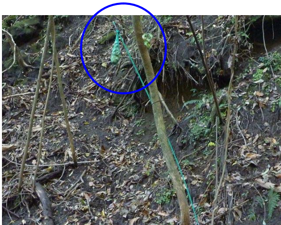
写真 2-4-2-1(3) 吊り下げ法（弾性ポール） 最低地上高約 120～140cm
