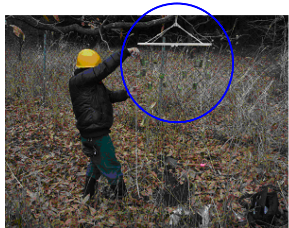
写真 2-4-2-1(4) 吊り下げ法（洗濯物干し） 最低地上高約 120～140cm
