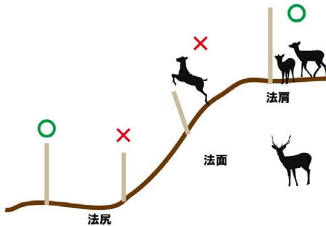
図 9-6 傾斜地での恒久柵設置ポイント
