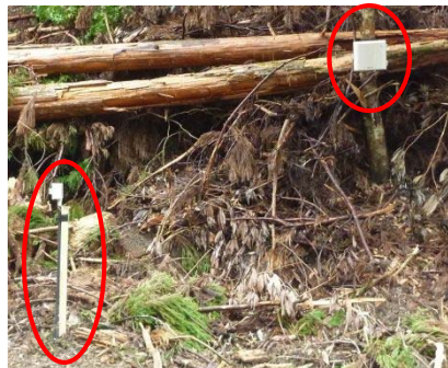
発砲ライフル音発生器 (左：センサー、右：発生器)
