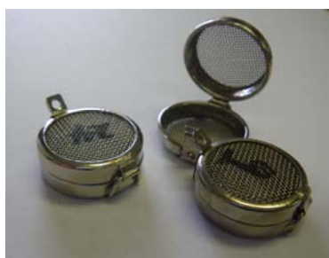
写真 2-9-2-2(1) 臨界点乾燥装置用包埋カゴ
