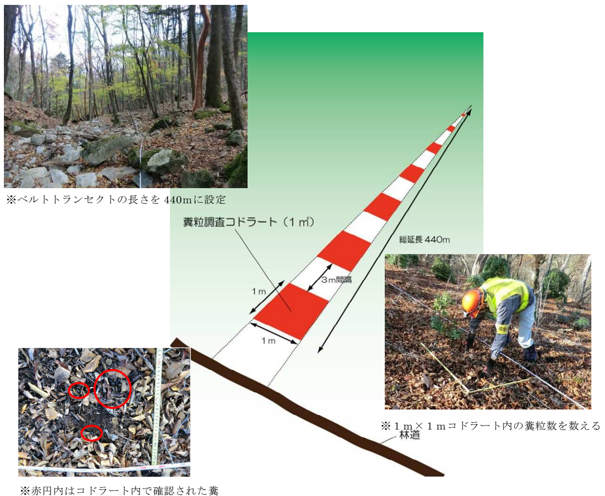
図 2-1-1-2 ベルトトランセクト法のイメージ
