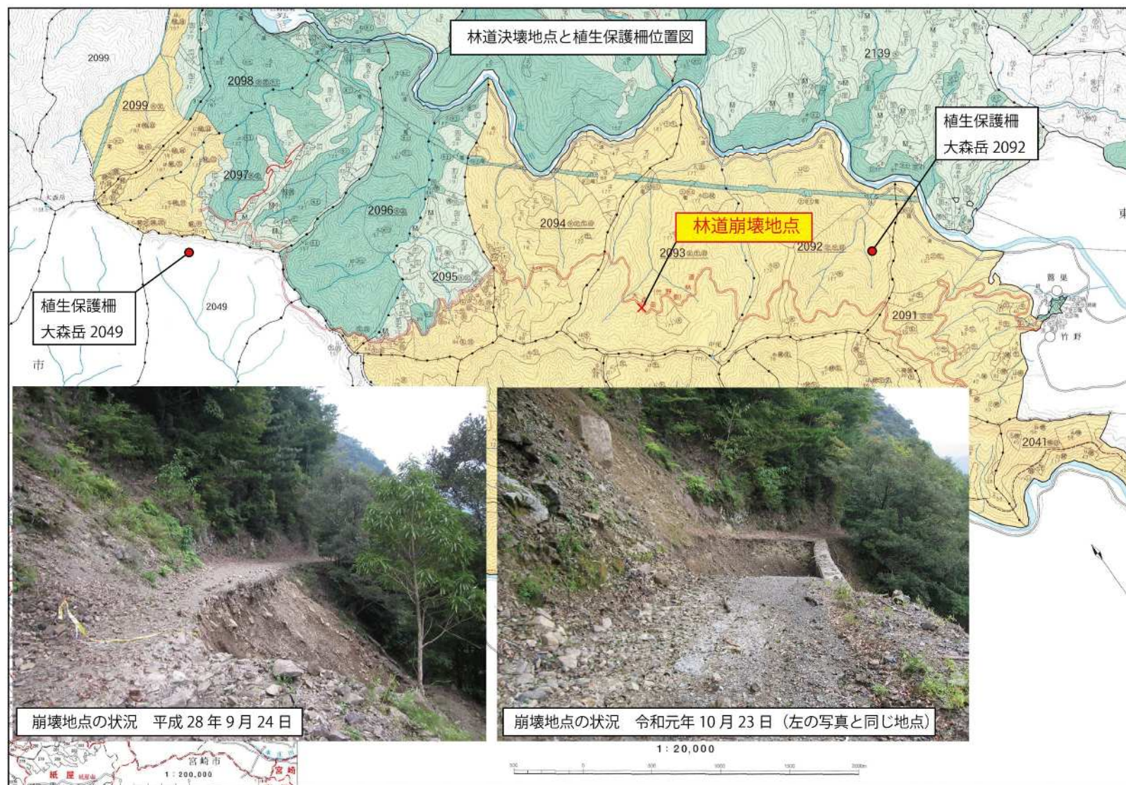
図 2-3-1-4 林道路盤の流出箇所と植生保護柵位置
