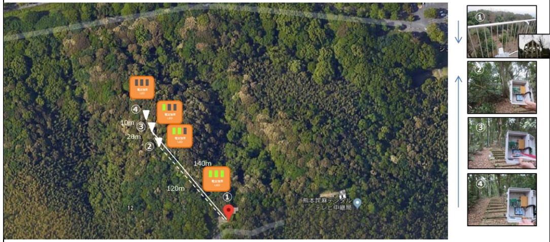
図 2.4.29 森林における電波伝搬試験(傾斜)結果
