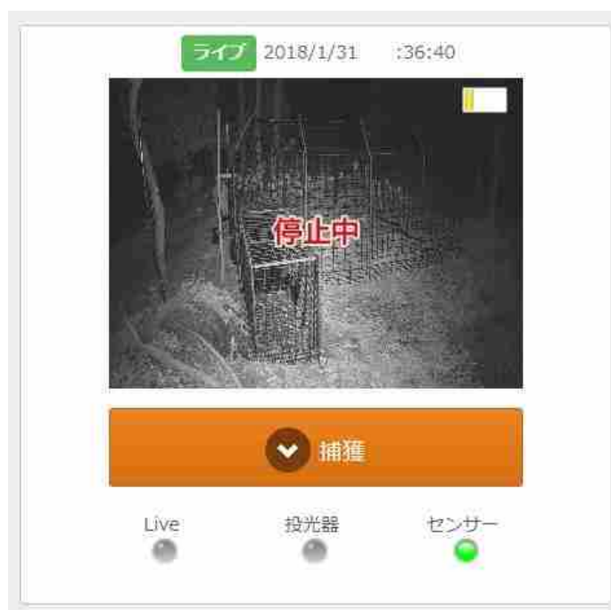
図 2.6.2 Web 上で確認できる囲いわなの様子 中央の「捕獲」ボタンをクリックすればゲートを閉じて捕獲可能 （上図は稼働時間（夜間）でないため「停止中」と表示されている）
